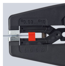
upínací čelisti z oceli zabraňují prokluzování vodiče
